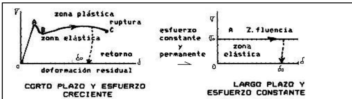
Figura 50. Carga creciente instantánea y carga constante prolongada.
