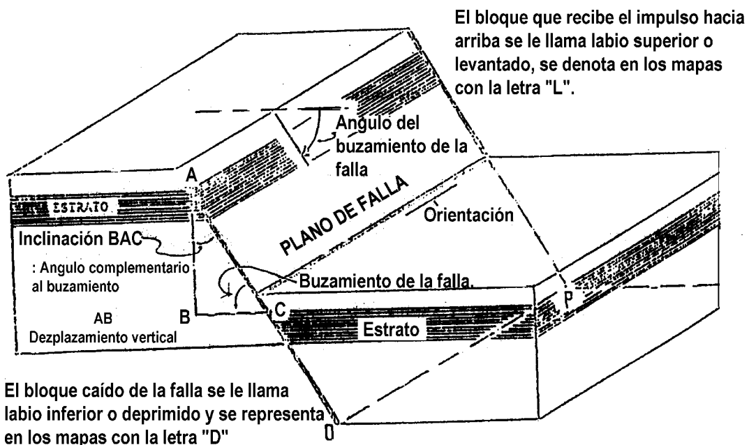
Figura 17: Elementos estructurales de una falla.
