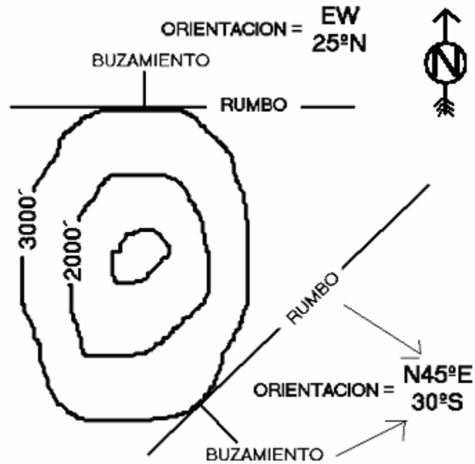
Figura 2: Rumbo y buzamiento en dos posiciones de un afloramiento.
