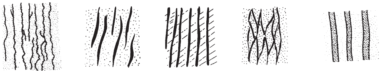
Figura 6-4- Tipos de clivaje espaciado. De izquierda a derecha: estilolítico, discontinuo, continuo, anastomosado y diferenciado.
