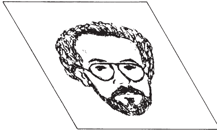
Figura 6-107- Sujeto pretectónico deformado por cizallamiento simple homogéneo. Se comporta como un marcador pasivo.
