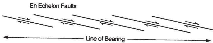
Figura 5-27- Fracturas dispuestas “en escalon”.
