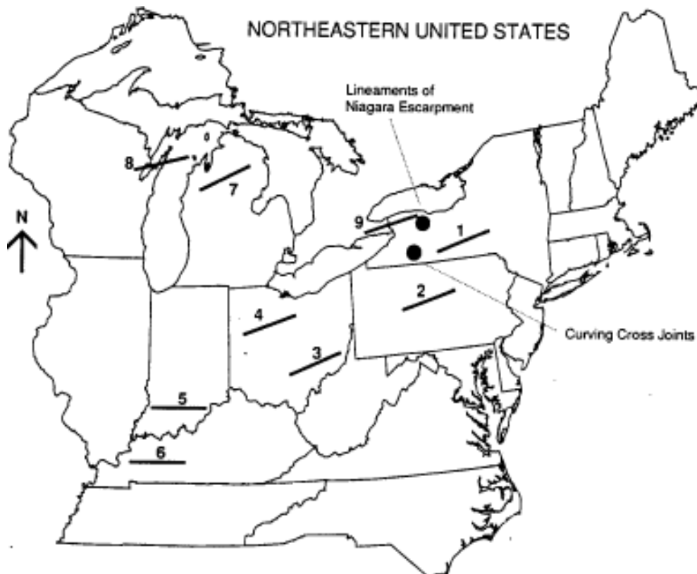
Figura 5-60- Orientación de diaclasas paralelas a campo de esfuerzos actual en el NE de los Estados Unidos (Gross y Engelder, 1991).
