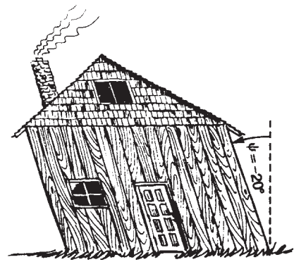
Figura 2-26- Cizallamiento simple de una cabaña. El ángulo de cizalla es de 20^\circ .
